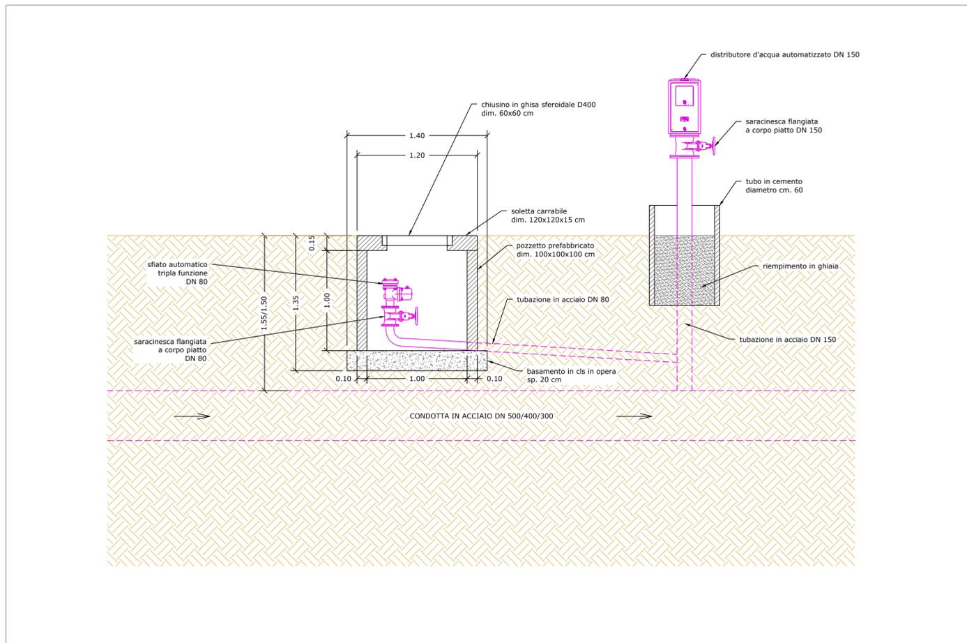
Schema tipo - gruppo di distribuzione dell'acqua irrigua automatizzato DN 100, con pozzetto prefabbricato per alloggiamento sfiato DN 80
